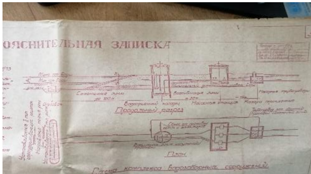
Attēls Nr.1 Tehniskā ūdens krasta aka
